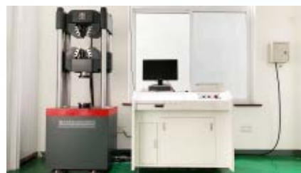
60吨万能试验机 60Ton Tensile Testing Machine
